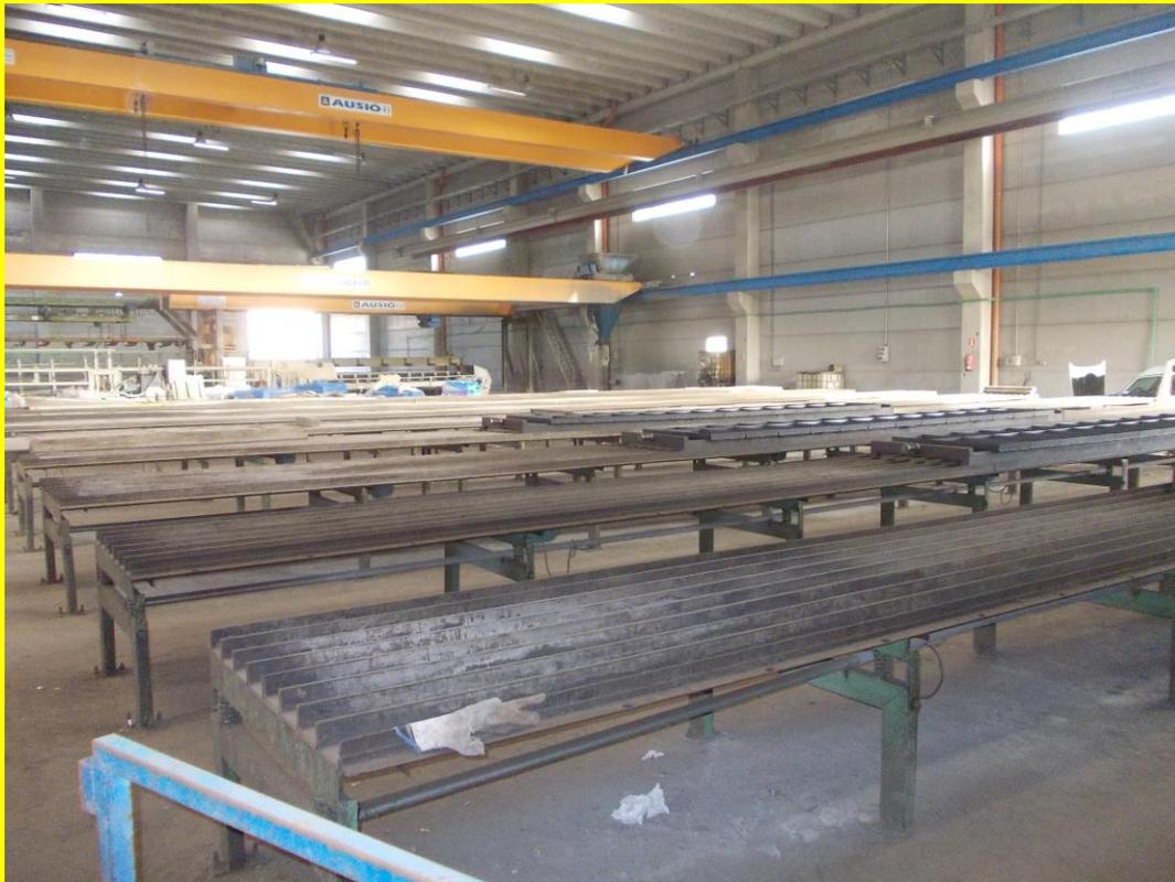
DESCRIPCIÓN: Mesa fija para vigueta armada especial, de 20 metros largo y con motores para vibrado.
