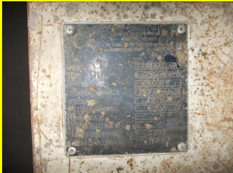
FUNCIÓN: DAR PRESIÓN A LA MÁQUINA DE TENSAR Y DESTENSAR.
