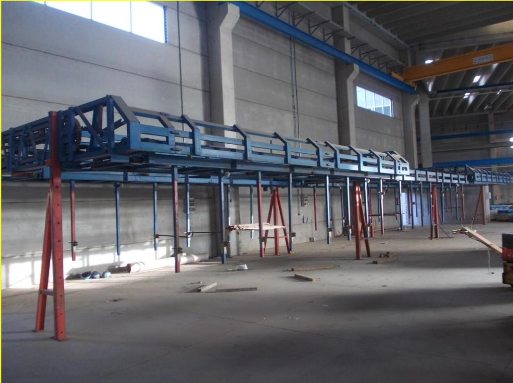
FUNCIÓN: MONTAJE DE HIERRO PARA VIGA Y PILAR.
