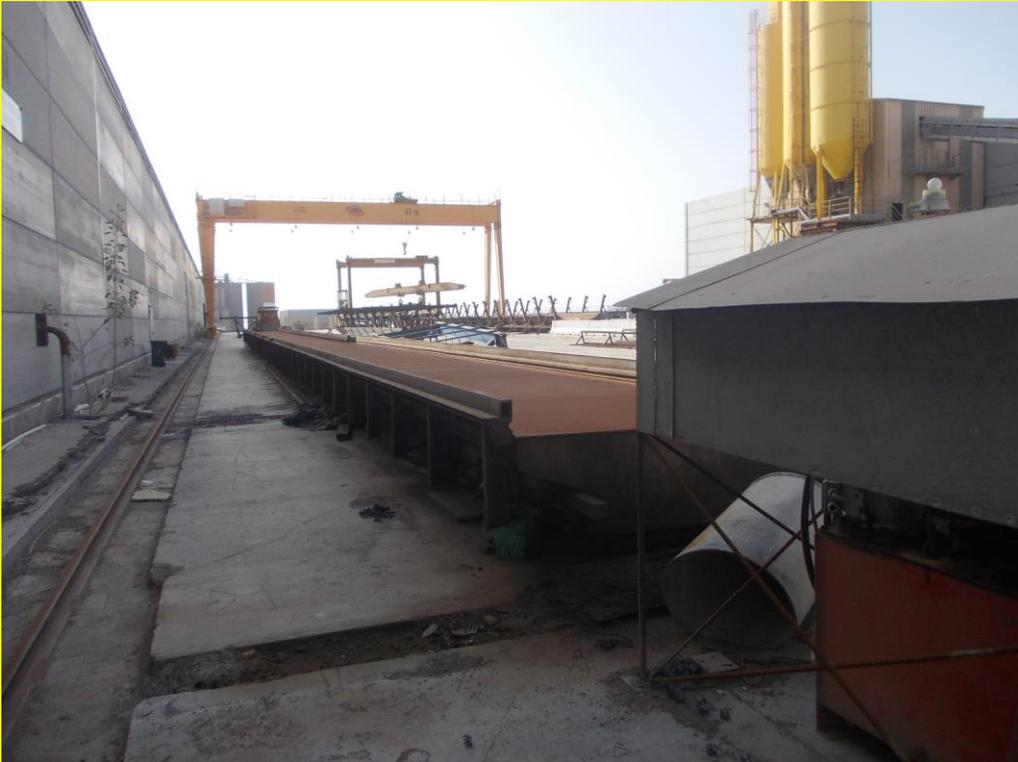
FUNCIÓN: Molde para fabricación de panel de fachada.
