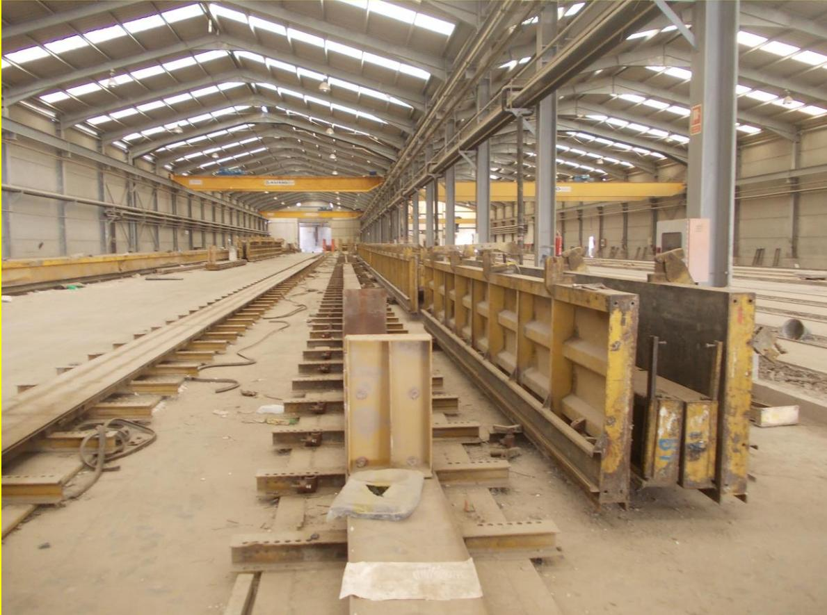
FUNCIÓN: MOLDES PARA FABRICACIÓN DE DISTINTOS TIPOS DE VIGA. ESTOS MOLDES SON ADAPTABLES PARA FABRICAR VIGAS SEGÚN SE REQUIERA.
