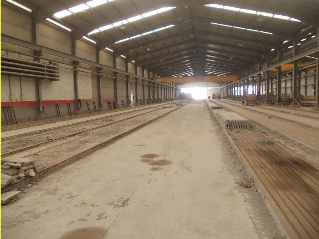
DESCRIPCIÓN Y FUNCIÓN: 8 Líneas de 120 metros lineales calefactadas para la fabricación de placa alveolar.
