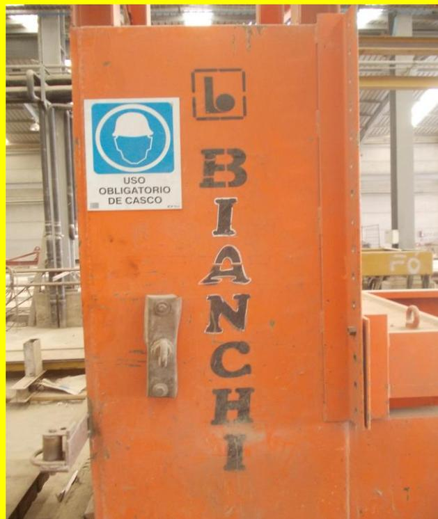
FUNCIÓN: TENSADO Y DESTENSADO DE HIERRO EN FABRICACIÓN DE VIGAS.
