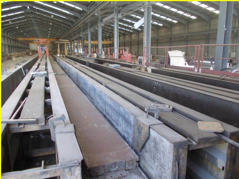
FUNCIÓN: MOLDE PARA FABRICACION DE PILAR.
